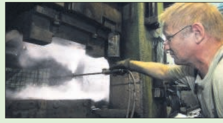
Ein Gabelstapler hilft beim Stapeln von Gitterboxen (F.I.). Uwe Vyskocil sprüht Greif-Trennmittel aus, damit das Aluminium beim Pressen nicht „anbackt“ und gut fließt (F.u.).
